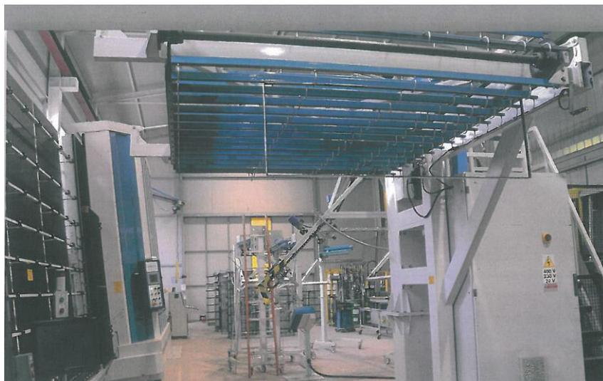
Anche la piegatura dei profili antirottura è automatizzata, come automatizzato è il sistema di produzione del vetro temperato grazie ad un grande forno "tempra" per prodotti basso-emissivi magnetronici.
