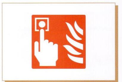
Fig. 7 - Cartello che indica il pulsante di segnalazione manuale d'incendio. Secondo la nuova norma, deve essere applicato in corrispondenza di tutti i pulsanti di segnalazione manuale di incendio.
